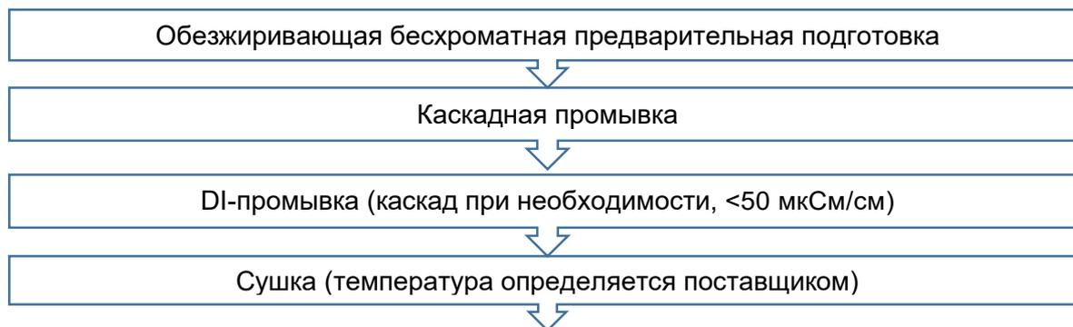
Помимо бесхроматного процесса защиты от коррозии (наименование продукта) используемый вариант процесса указывается в аттестате. Поскольку испытание для получения аттестата включает только характеристики антикоррозионной защиты продукта для бесхроматной предварительной обработки, средство очистки не будет указано.
